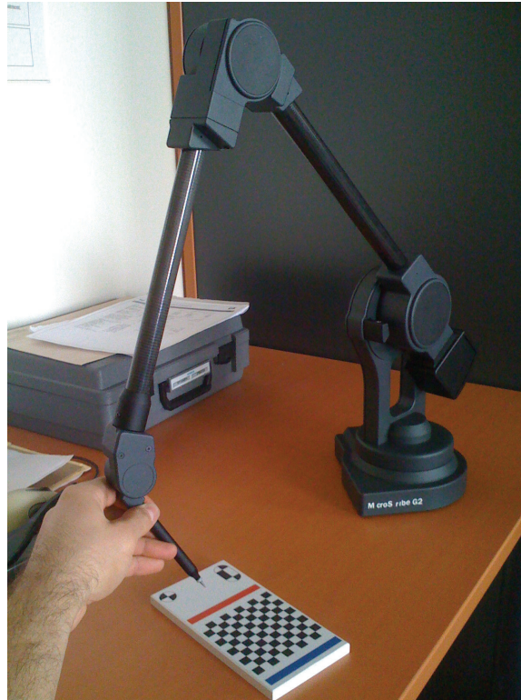
Figure 2.15. MicroScribe utilisé pour numériser l'objet de calibrage
